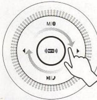
Dans le sens des aiguilles d'une montre pour augmenter le volume, il y aura des bips quand le volume au maximum
