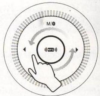
Dans le sens inverse des aiguilles d'une montre pour diminuer le volume, il y aura des bips quand le volume est au minimum
